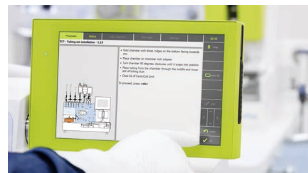
Figure 2 : CliniMACS Prodigy Tubing Setの取り付けガイド
