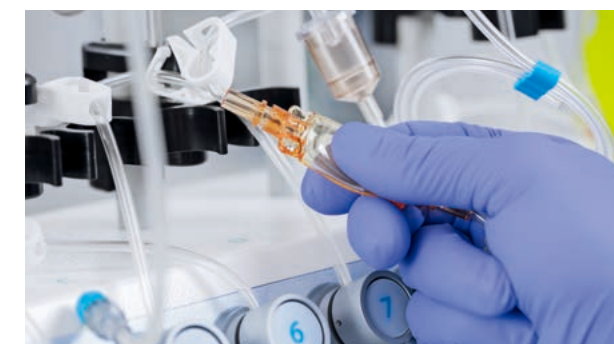
Figure 4 : サンプルポーチにより、細胞製造の工程中に簡単かつ無菌状態を保ったままサンプリングが可能
