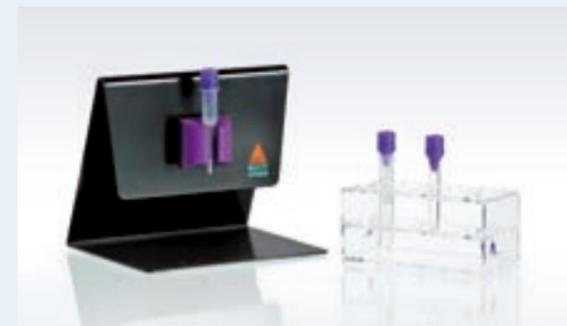
Figure 3 : MidiMACS™セパレーターにセットした MACS カラム。
